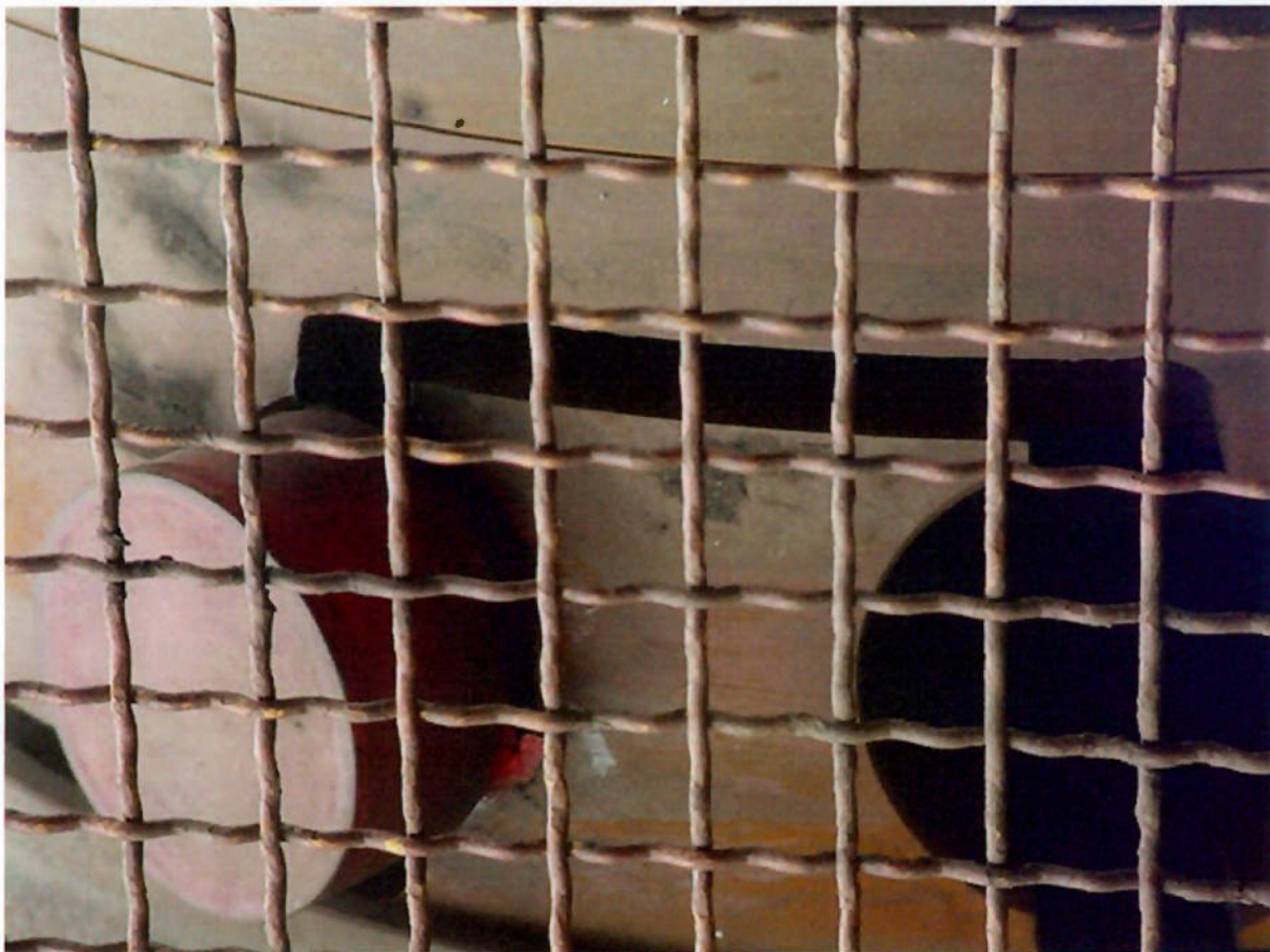
Figura 12 – Fuga do elemento elástico
